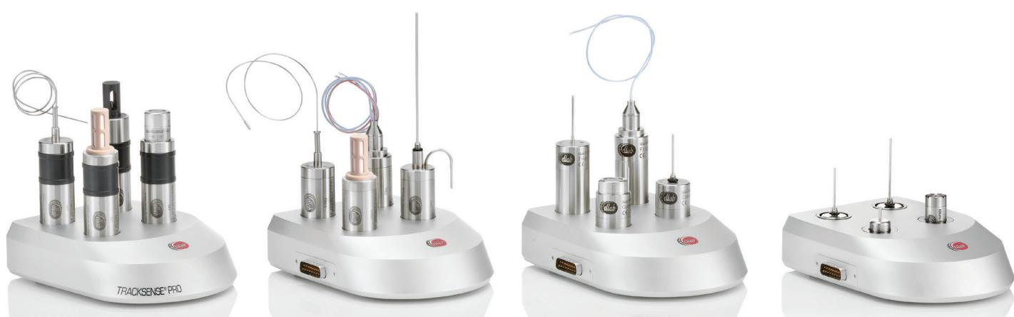
The TrackSense® Pro 多功能读数台可与Micro、Mini、Compact、Frigo或Pro记录仪模块相结合,允许同时启动16台记录仪。
