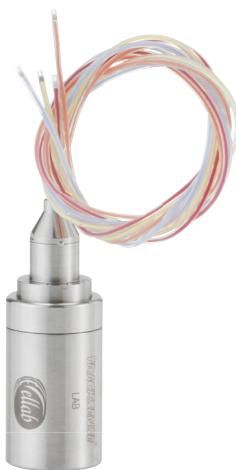
实验室记录仪设计有四个温度通道。电缆有不同的颜色，便于识别。
