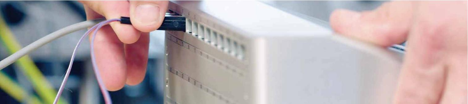
E-Val Pro主机有4到40个通道，可以处理任何类型的热电偶、模拟或数字传感器(压力/湿度)，以及数字输入/输出信号。
